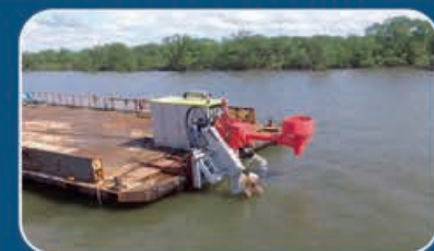
SISTEMA PORTÁTIL DE PROPULSÃO FORA DE BORDA HIDRÁULICO: COMPACTO DE FÁCIL INSTALAÇÃO, EFICIÊNCIA EM MANOBRABILIDADE
