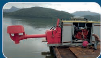
SISTEMA PORTÁTIL DE PROPULSÃO FORA DE BORDA HIDRÁULICO: COMPACTO DE FÁCIL INSTALAÇÃO, EFICIÊNCIA EM MANOBRABILIDADE
